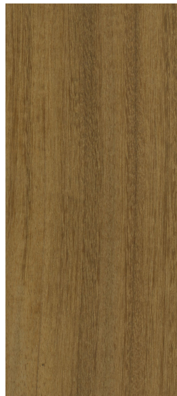
Débit sur faux quartier
