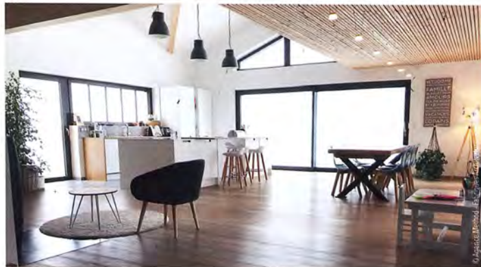
Minco a élaboré de nombreuses baies à levage qui offrent la possibilité de grandes largeurs en restant en deux vantaux. Le levant coulissant permet un apport lumineux important tout en étant très performant sur le plan thermique
