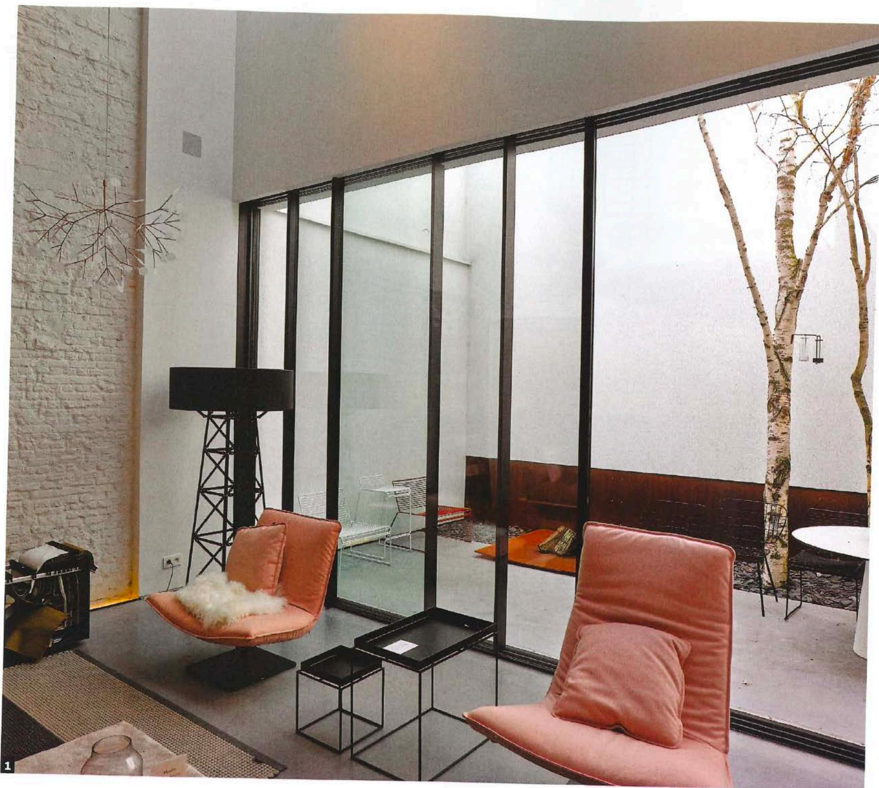
**1. Artline XL** Coulissant en aluminium avec montants fins de 26 ou 38 millimètres, permettant de réaliser des ouvertures de grandes dimensions tout en minimisant les masses vues (Sapa). Ouvrant invisible et dormant intégré à la maçonnerie, existe aussi en version d'angle. Hauteur maximum sans reprise : 350 centimètres. Prix selon devis. [www.sapabuildingsystem.com](http://www.sapabuildingsystem.com)
